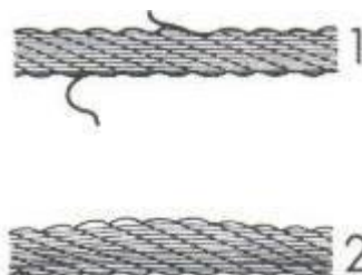
Рис.5 Проверка троса: (1)– использовать трос запрещено; (2) – трос готов к использованию.
